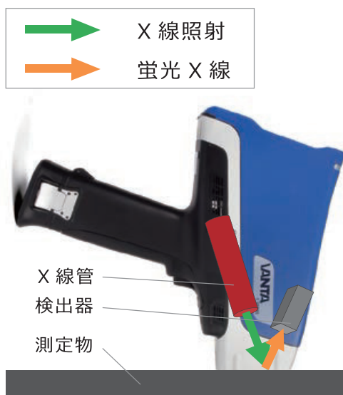
分析時のX線照射・蛍光X線検出イメージ
