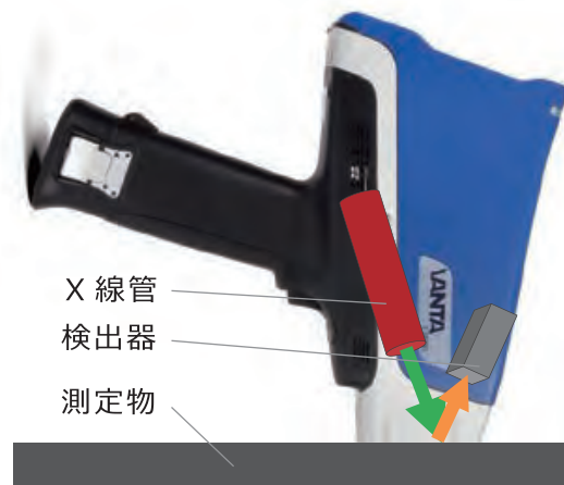
分析時のX線照射・蛍光X線検出イメージ
